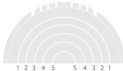
**PT** Corte as máscaras ao longo das linhas radiais para estreitar o diâmetro de detecção.
